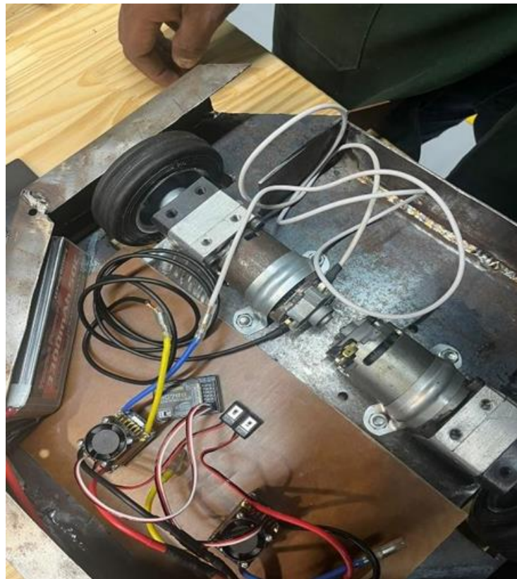
Figura 3 – 3 ESC's, 2 motores, 2 baterias, 2 redutores, 1 controle e receptor.
